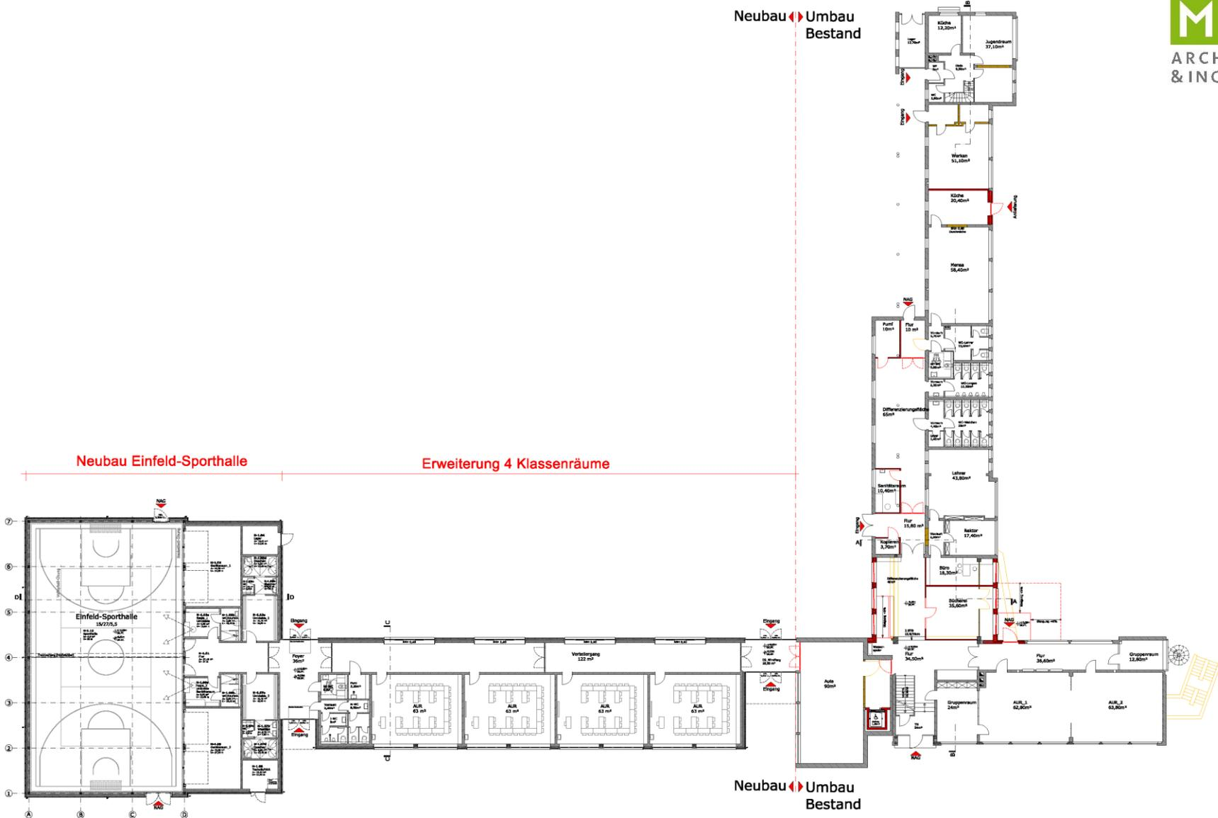
Grundriss Erdgeschoss VGS Glarum Erweiterung und Neubau einer Einfeld-Sporthalle
