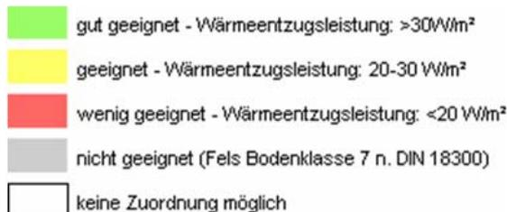
Abb. 36: Potenzielle Standorteignung für Erdwärmekollektoren<sup>22</sup>
