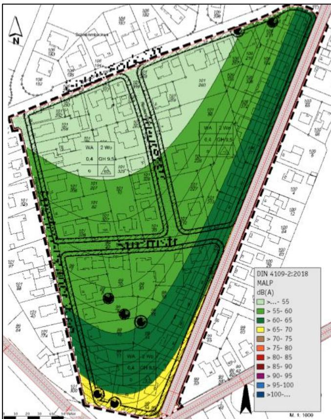
**Abb. 6: Maßgebliche Außenlärmpegel nachts nach DIN 4109 (itap 2021, S. 16)**
