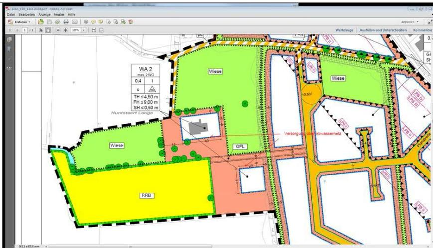
Ich schlage wie folgt vor, das gesamte Baugebiet Huntsteert Abwassertechnisch über das Nord-westlich gelegene Baugebiet Höpkenmoor zu erschließen. Und zwar abgehend von der Wendeanlage Höpkenmoor von der dort befindlichen Pumpenstation in Richtung Süden über den dort mit Geh Fahr und Wegerecht zu belastenden Fuß und Radweg der Stadt Schortens. Am Endpunkt des Weg in Richtung Osten bis zur Ecke Lagerplatz.
